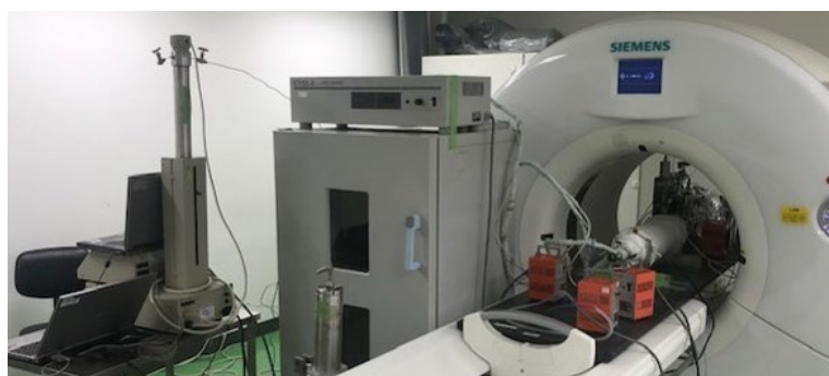
図 3 X 線 CT 内で行うコア流動試験装置の外観
